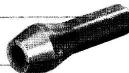
Fig. 3. De spantang voor een snelle en nauwkeurige plaatsing van het boortje.
